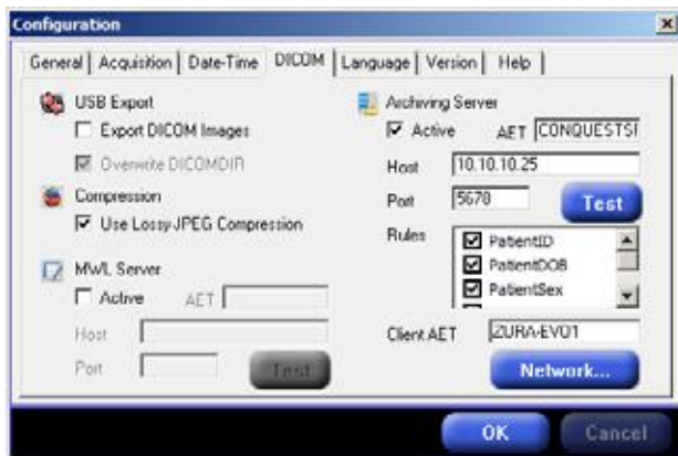
Fig. 93 Configuration > DICOM tab
